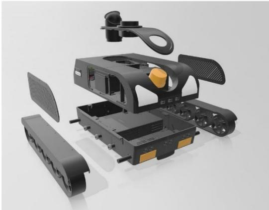
*Figura 2: Modello 3D esploso di **WatchMan**, che evidenzia la progettazione modulare. Si distinguono la base con telaio inferiore (parte centrale, con supporti per i cingoli), la scocca superiore (con frontale arrotondato e vano per sensori), i **cingoli** laterali (separati ai lati) e altri componenti smontati (pannelli con griglie di aerazione, alloggiamenti sensori, etc.). Questa configurazione facilita l'accesso ai componenti interni e la sostituzione di parti in caso di upgrade o guasti.*
