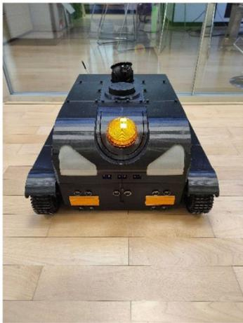
*Figura 1: La versione preindustriale **WatchMan** Beta v1.0 assemblato e pronto per i test, in vista frontale. Si notano il sistema a cingoli, la telecamera panoramica 2.4 GHz Wi-Fi installata sulla sommità e il lampeggiante di segnalazione frontale (condizione di sicurezza normale, luce arancione fissa).*
